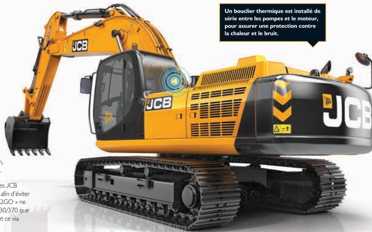
Un bouclier thermique est installé de série entre les pompes et le moteur, pour assurer une protection contre la chaleur et le bruit.
