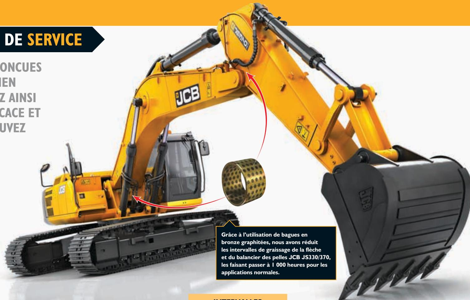
Grâce à l'utilisation de bagues en bronze graphitées, nous avons réduit les intervalles de graissage de la flèche et du balancier des pelles JCB JS330/370, les faisant passer à 1 000 heures pour les applications normales.
